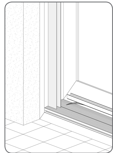
Profil dolny PDS MPH (Montaż z drzwiami typu HS)
